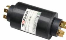
MW4045是插片式无水银大电流滑环，除具备常规滑环特点外，还具有连接方便，载流能力更强等特点；可替代传统式的水银滑环；为工业制造业设计的无水银滑环，完全满足欧盟环保要求。导电环采用贵金属镀敷处理，电刷采用贵金属合金丝，采用标准的扁平接头方便连接。
